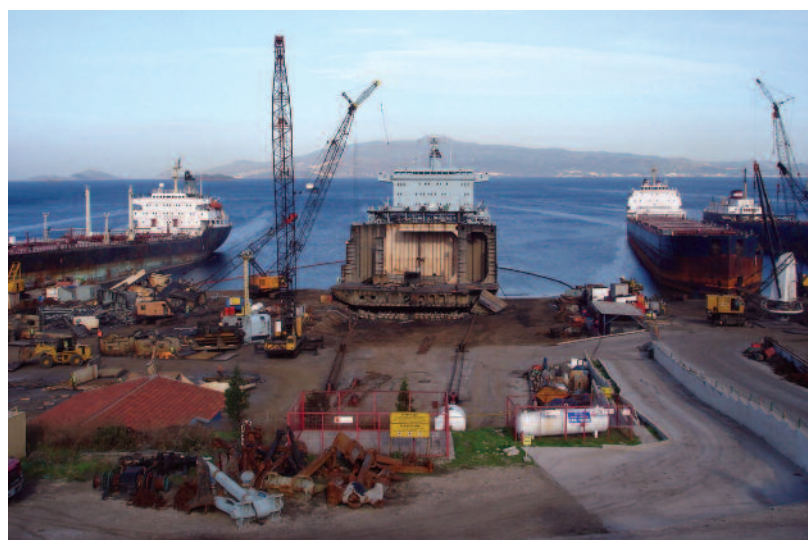
Fig. 2: Leyal Ship Recycling Ltd., en Turquía, una de las cada vez más numerosas instalaciones de reciclaje de buques que tienen ya certificado su cumplimiento con el Convenio de Hong Kong de la OMI. La mayoría se encuentra en China, Turquía y Japón.
