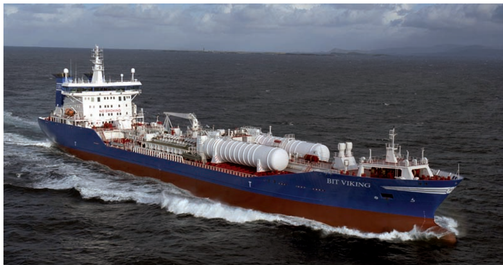
El buque Bit Viking está equipado con dos motores duales que le permiten navegar 12 días quemando GNL.
