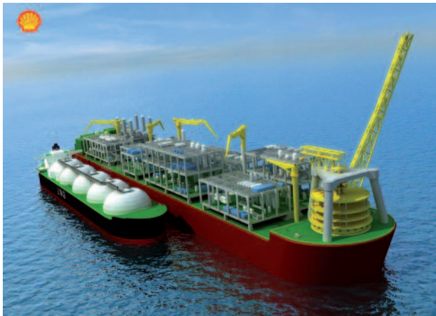
Recreación por ordenador del FLNG Shell Prelude transfiriendo GNL a un metanero.
