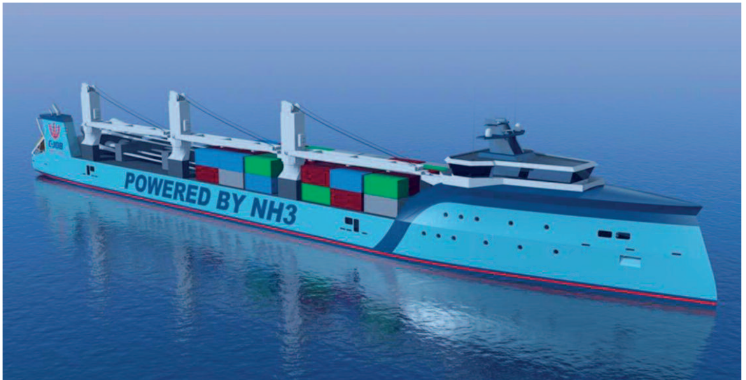
Fig. 4: El amoníaco ( \text{NH}_3 ) podría usarse como un portador de hidrógeno, evitando la necesidad de disponer de una planta criogénica a bordo.
