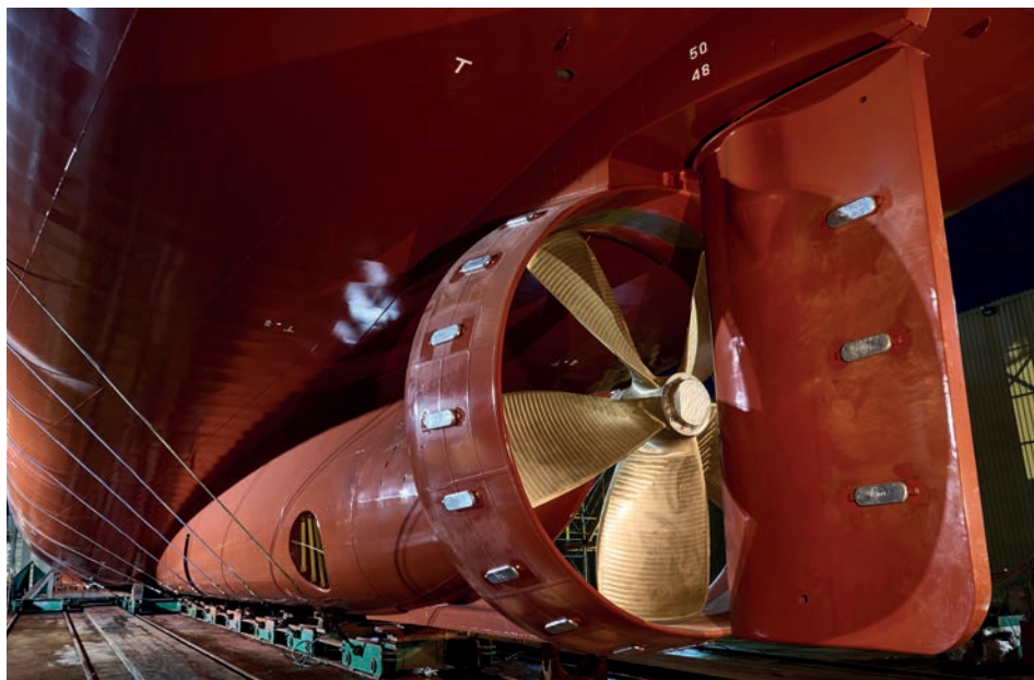
El diseño optimizado de las hélices y la geometría de las palas son tecnologías fundamentales para reducir el ruido submarino radiado de los buques // VICUSDT.
