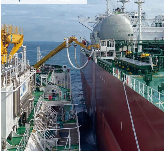
Operación de suministro ship to ship de GNL como combustible a un buque / MPA SINGAPORE.
